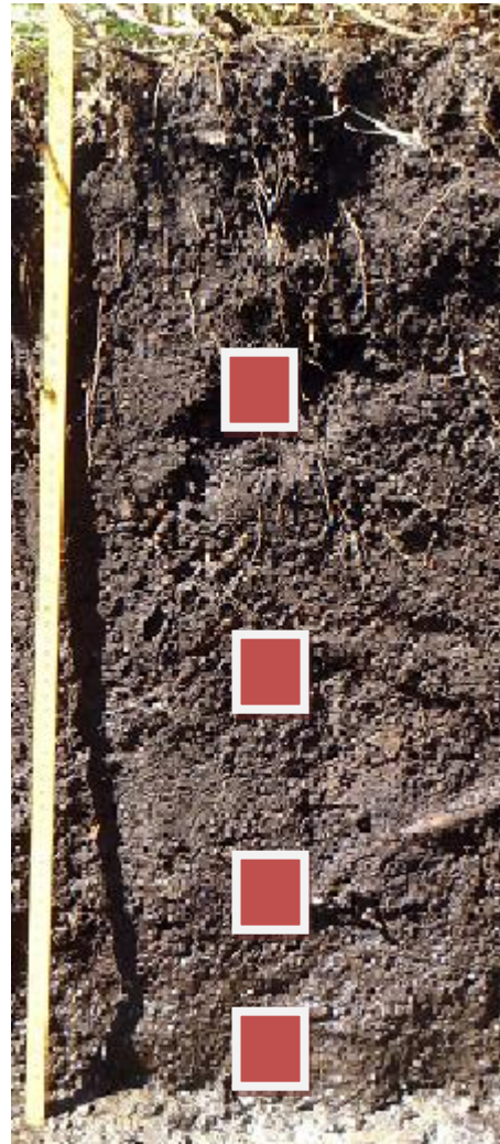
Fig 3. Sektion ur dike med provpunkter markerade, sektionen mäter 82 cm.
